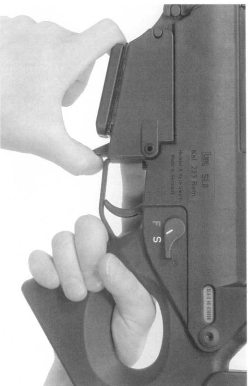
Fig. 23 Spingere la leva di tenuta del caricatore in avanti
