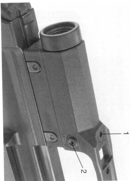
Fig. 43 Maniglia di trasporto con visore montata direttamente sull'arma
